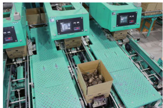
④形状選別機でサイズ分けされた サトイモを自動秤量・箱詰
